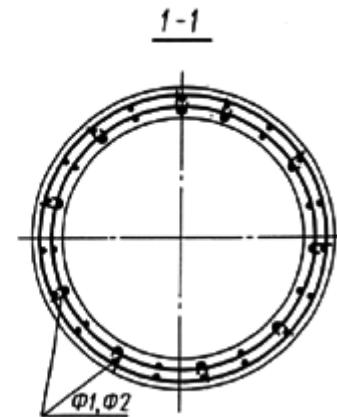
*Деталь армирования стенки трубы*
