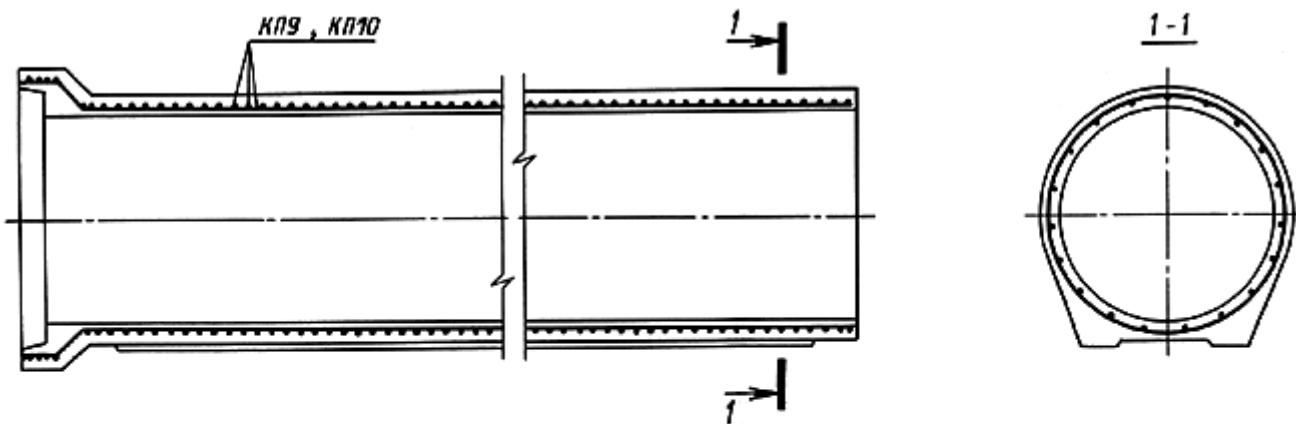
*Деталь армирования стенки трубы*
