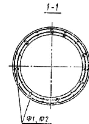
*Деталь армирования стенки трубы*
