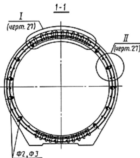
*Деталь армирования стенки трубы*
