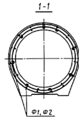
*Деталь армирования стенки трубы*
