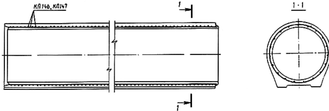
*Деталь армирования стенки трубы*
