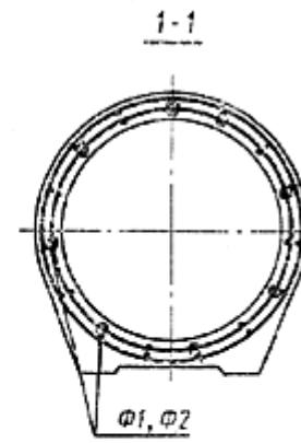
*Деталь армирования стенки трубы*
