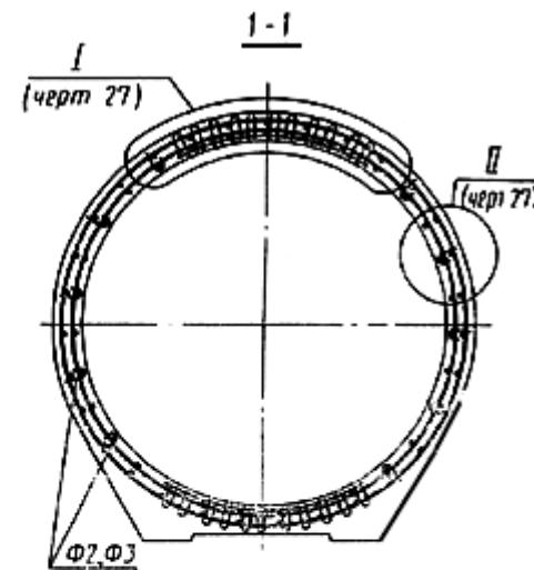
*Деталь армирования стенки трубы*
