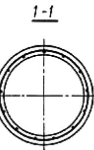
*Деталь армирования стенки трубы*
